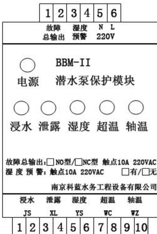
模块 12VAC 供电接线端子图
